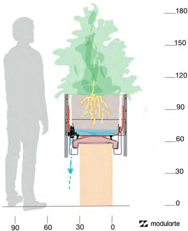
Fioriere su muretti con copertine non piane: i piedini in acciaio inox regolabili a vite livellano la fioriera, mentre in telaio interno provvisto di zanche regolabili bloccano la fioriera sul muretto
