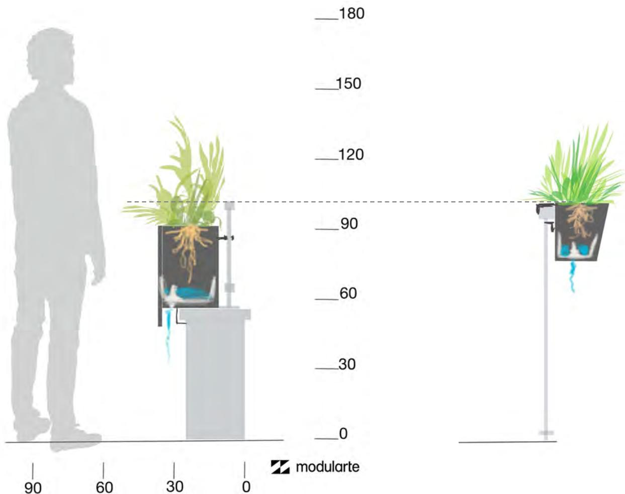
Ad qualsiasi parapetto si possono fissare le fioriere, quindi in appoggio e imbullonate alla ringhiera; ogni installazione realizziamo staffe in acciaio per un fissaggio sicuro anche in caso di forte vento.
