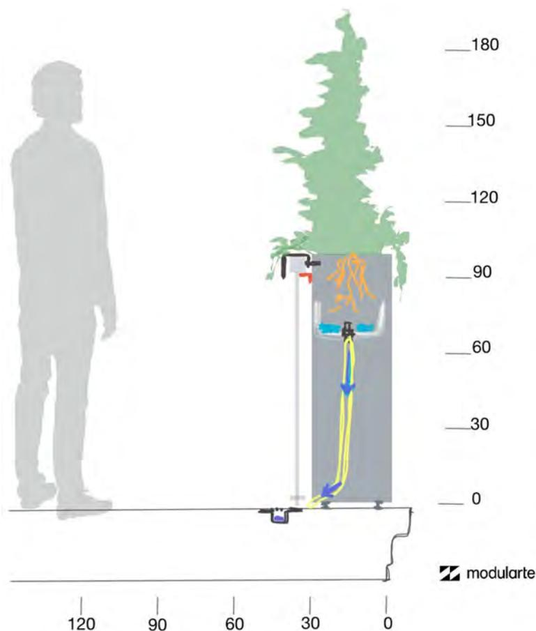
Le fioriere possono essere montate all'esterno della ringhiera con sistema di fissaggio a ringhiera.
